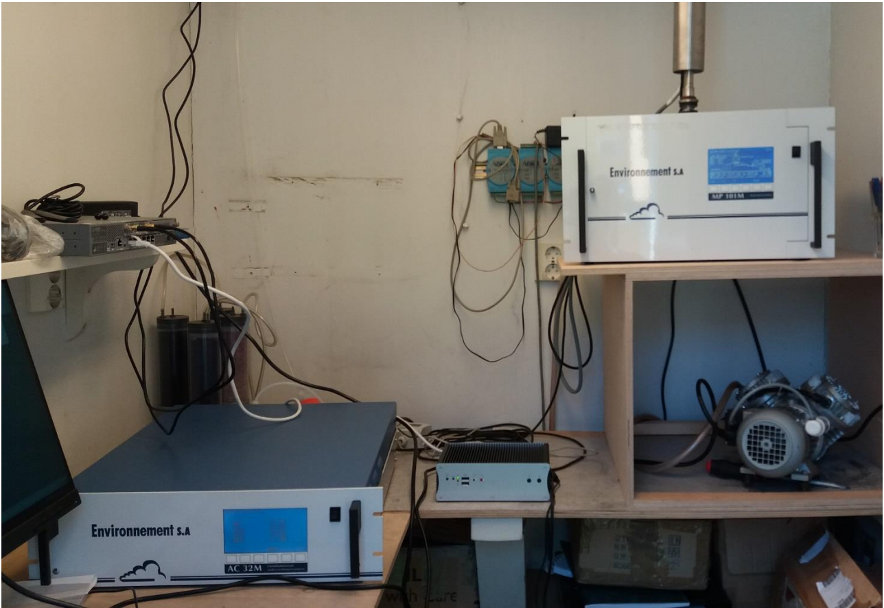
Kuva 2. Hallikadun mittausaseman laitteistoa, oikealla PM10-mittauslaite, vasemmalla huhtikuussa 2023 uusittu NOx-mittauslaite.
