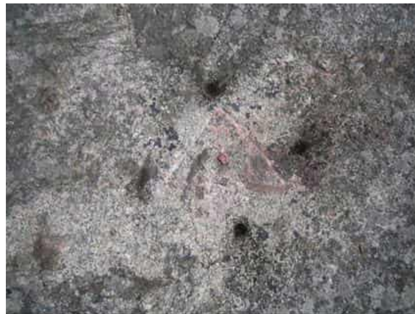
Kokkovuoren kolmiomittauspisteen kaiverrus ja reiät. Kuva T. Vasko.
