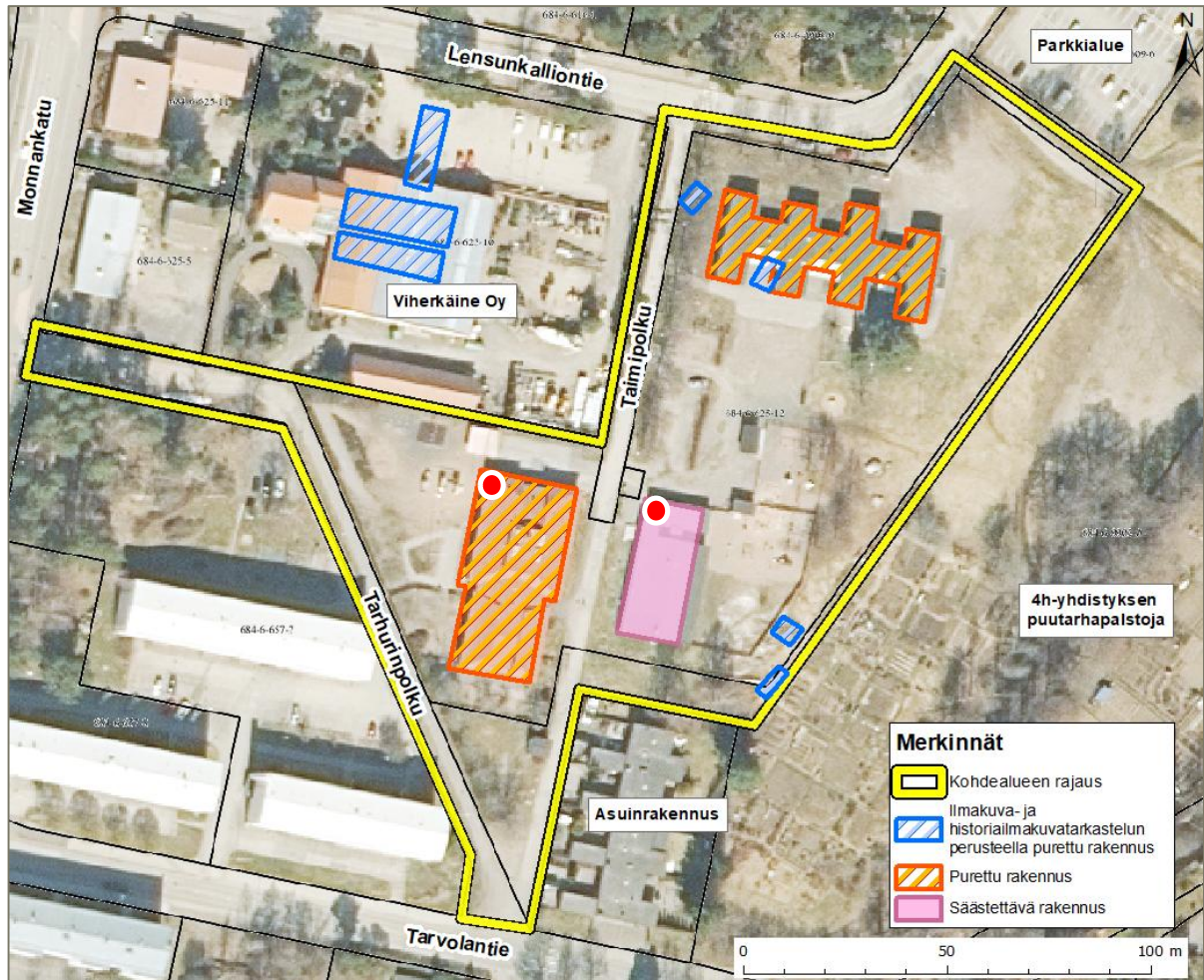
Kuva 7. Kuvassa on esitetty jo purettujen rakennusten sijainteja, kiinteistöä ympäröiviä toimintoja sekä säästettäväksi suunnitellun päiväkotirakennuksen sijainti. Lämmitysöljysäiliöiden sijainti rakennuksissa merkitty punaisella ympyrällä. Pohjana on Maanmittauslaitoksen ortoilmakuva vuodelta 2019.
