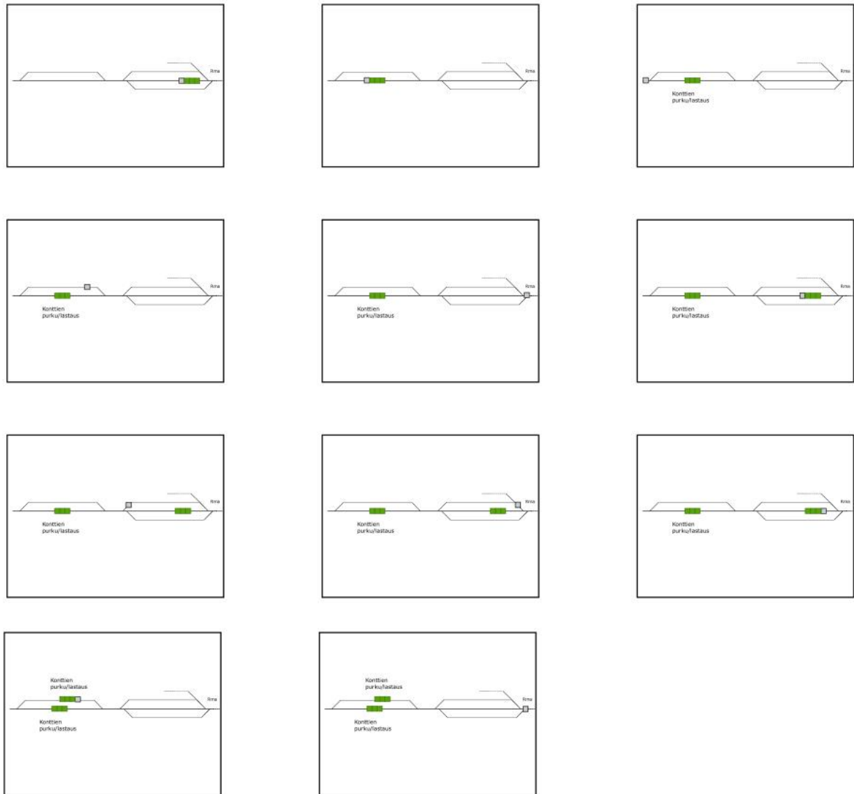
Kuva 20. Satamaratapihan ja satamaraiteiston keskeiset vaihtotyöliikkeet, vain kaksi junarunkoa.
