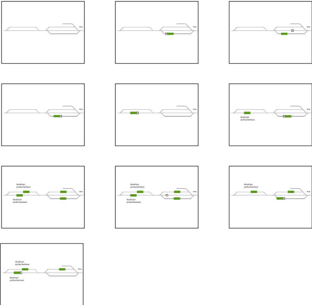
Kuva 19. Satamaratapihan ja satamaraiteiston keskeiset vaihtotyöliikkeet, maksimimäärä junarunkoja. Harmaa neliö tarkoittaa veturia ja vihreät neliöt vaunuja (Liite 7).
