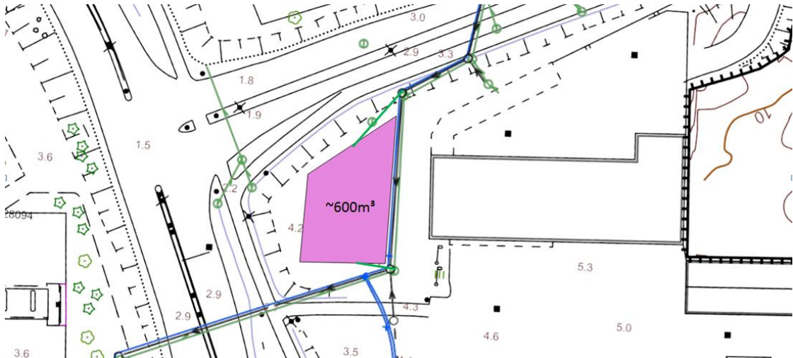
Kuva 29. Nykyisen hulevesiviemärin yhteyteen ehdotetaan rakennettavan maanalainen viivytyksrakente, jossa hidastetaan hulevesivirtaamia ennen Kukonkarinkadun runkolinjaa. Kuvassa esitetyn kennoston muoto on viitteellinen, kuvan tarkoituksena on hahmottaa noin 300m 2 suuruisen pinta-alan kokoa. Kennosto olisi noin 2m korkea ja pinta-alaltaan 300 m 2 .
