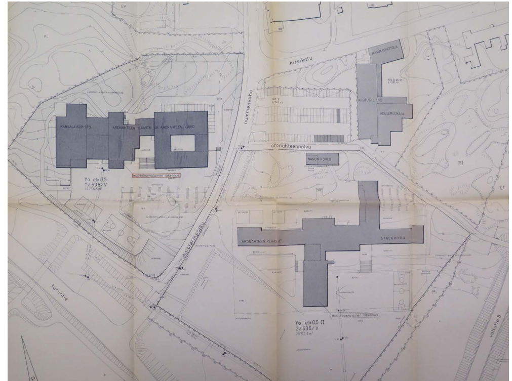
Koulualueen asemapiirros vuoden 1979 muutospiirustuksissa (Tuula Stolt). Uusi keskusruokalarakennus on valmistunut, kuten sen länsipuolella edelleen oleva paikoitusaluekin. Paikoitusalueen eteläpuolella ollut pienempi Nanun kouluun kuulunut rakennus on sen sijaan sittemmin purettu. Rakennuksen paikalla on nykyään aidattu leikkipuu-alue. Muilta osin ympäristö toimintoinen on säilynyt tähän päivään. (Rakennuspiirros Rauman kaupungin rakennusvalvonta).
