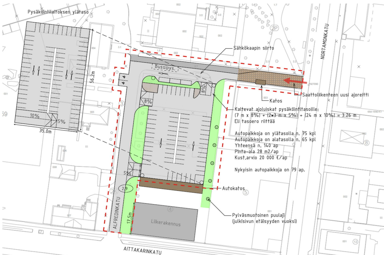
Kuva. Ote Vanhan Rauman OYK:n liikenneselvityksestä (Sito). Suunnitelmassa on tutkittu kaksikerroksista pysäköintilaitosvaihtoehtoa kaltevilla ajoluiskilla. Saattoliikenteelle on osoitettu reitti Nortamonkadulta. Laitoksen itäreunalle jätetty tilaa pylväsmuotoisille puille ja pysäköintilaitoksen alataso on painettu nykyisen maanpinnan alapuolelle.
